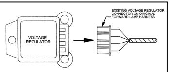
REMOVE EXISTING VOLTAGE REGULATOR CONNECTOR ON ORIGINAL FORWARD LAMP HARNESS FROM VOLTAGE REGULATOR AS SHOWN.
